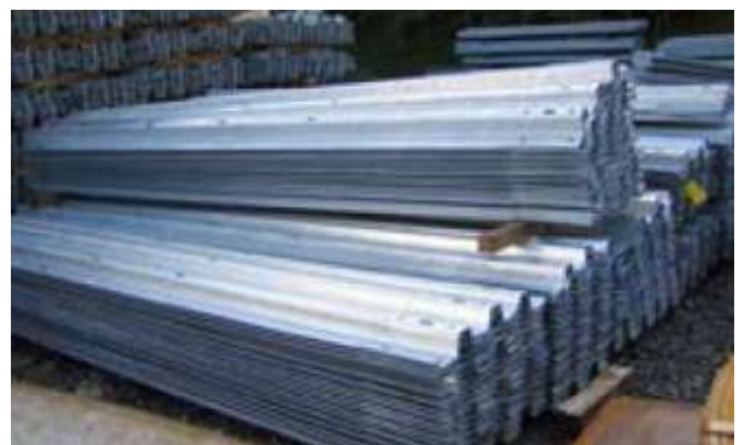
Figura 3.- Almacenamiento inadecuado de ángulos galvanizados
